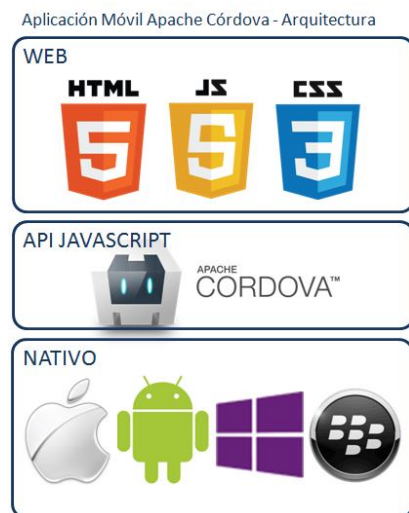
Figura 4 – Aplicación Móvil Apache Córdoba – Arquitectura
